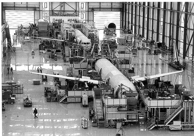
图4 德国汉堡总装厂A320飞机脉冲移动总装生产线
