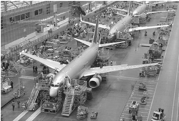
图2 B737飞机连续移动总装生产线
