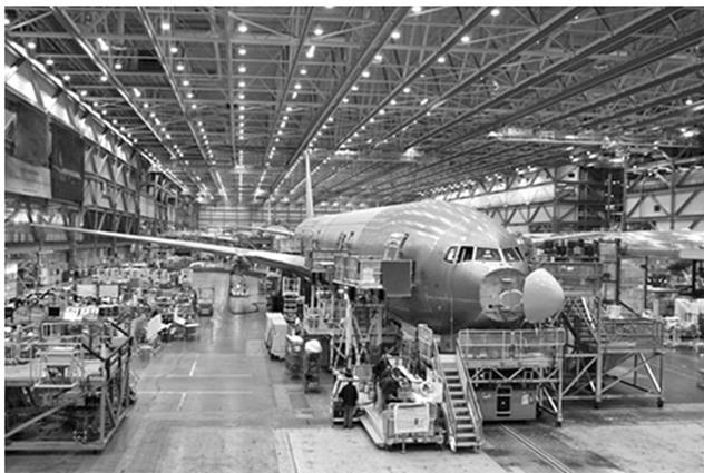
图3 B777飞机连续移动总装生产线
