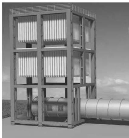
图5 矩阵式消声元件示意图
